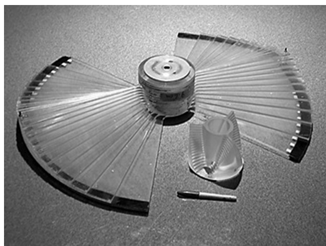
Рис. 16. Модулятор пробегов в виде вращающегося колеса («пропеллер»)
