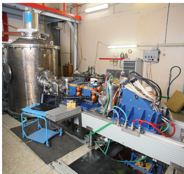
Рис. 4. Ускоритель-тандем с вакуумной изоляцией: общий вид (слева), схема (справа):
