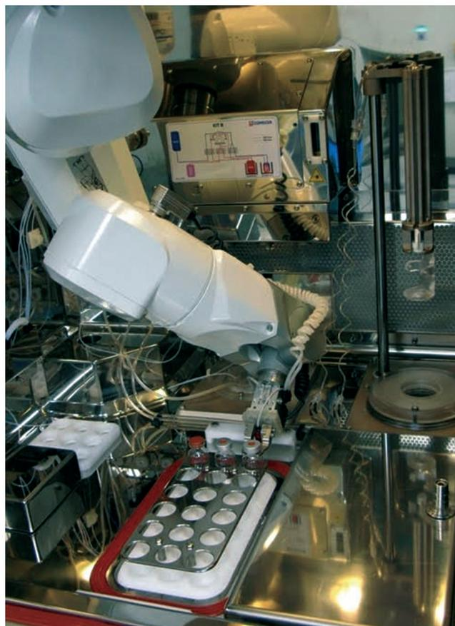
Рис. 4. Роботизированная система фасовки РФП Theodorico (COMECER, Италия)
