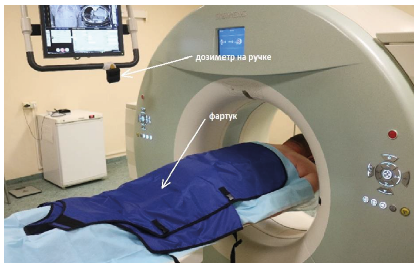
Рис. 2. Расположение дозиметра для оценки эффекта накрывания пациента радиозащитной пластиной (фартуком) на дозу в предполагаемых областях головы и шеи хирурга
