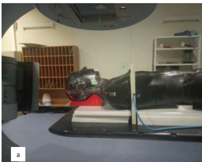
Рис. 4. Фантом Alderson-Rando с адаптерной пластиной, вставленной на разных уровнях: а — 10 см от края поля, б — 57,5 см — соответствует низу живота
