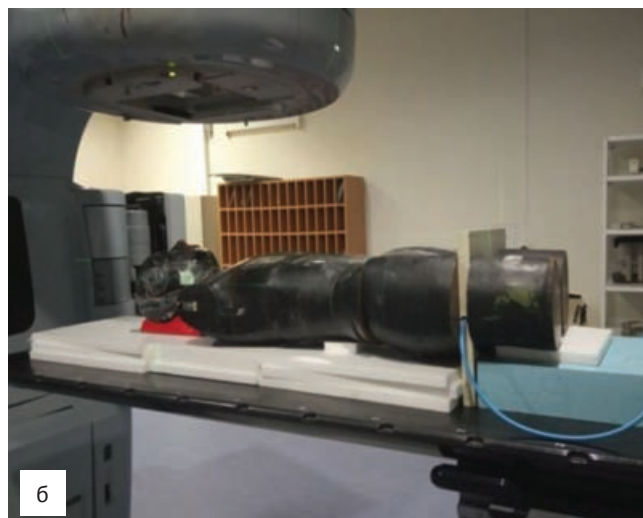
Рис. 4. Фантом Alderson-Rando с адаптерной пластиной, вставленной на разных уровнях: а — 10 см от края поля, б — 57,5 см — соответствует низу живота
