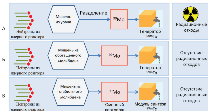
Рис. 3. Схемы получения технеция- ^{99\text{m}}\text{Tc} : А — классическая урановая технология; Б — безотходное производства сорбционных генераторов технеция- ^{99\text{m}}\text{Tc} на исследовательском ядерном реакторе ИРТ-Т ТПУ; В — автоматизированный модуль получения ^{99\text{m}}\text{Tc}
