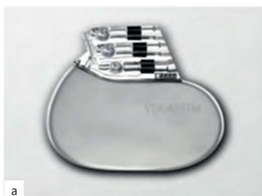
Рис. 2. а — российский трехкамерный кардиостимулятор «Вегаритм»; б — российский однокамерный малогабаритный кардиостимулятор VIRSAR SR
